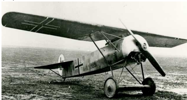
Fokker D-VIII parasol monoplane, 1918. Wikimedia Commons.
